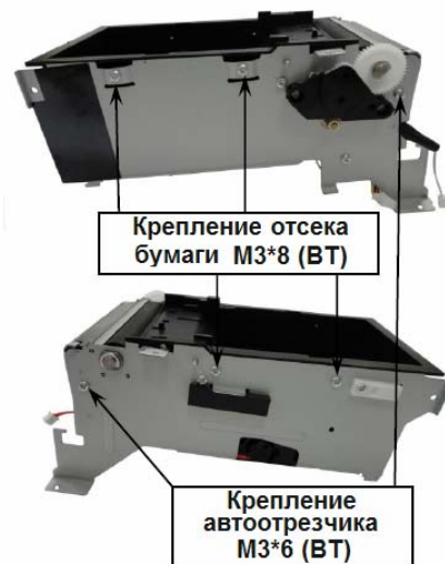
Рисунок 20 Крепление отсека рулонной бумаги и автоотрезчика к раме ККТ
