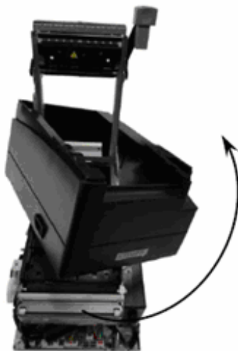
Рисунок 8 Снятие корпуса печатающего устройства
