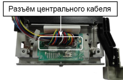
Рисунок 13 Разъем центрального кабеля
