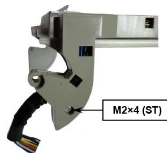
Рисунок 14 Снятие кожуха центрального кабеля
